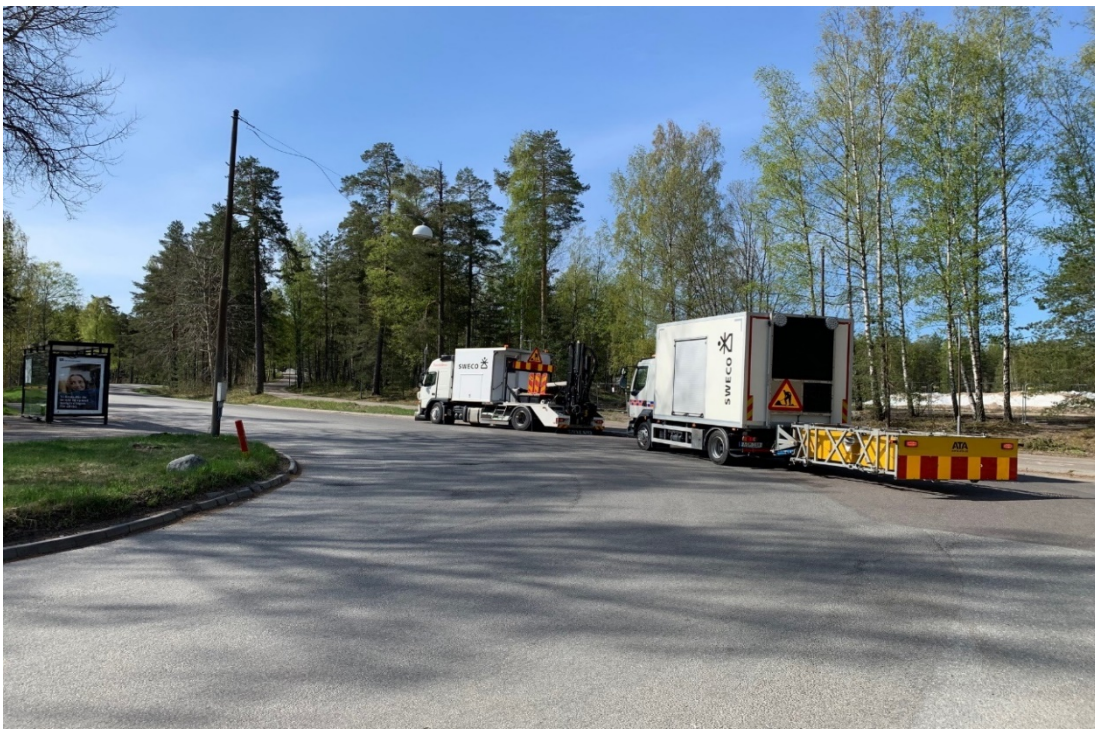
Foto 5.1. Visar den s.k. underlätaren samt medföljande TMA-fordon vid norra delen av Åstadalsvägen.
