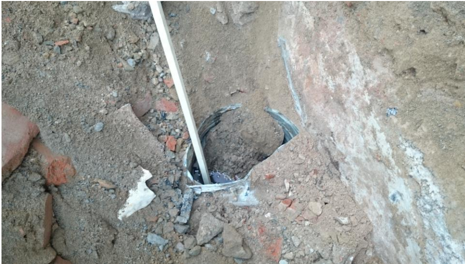
Bild 4; Behållare med hydraulolja påträffad inom Fåfängan 1 i provgropen PG2.
