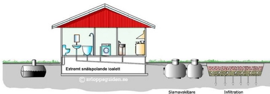
Bild: Principskiss för slutna tank för WC i kombination med infiltration ( www.avloppsguiden.se )
