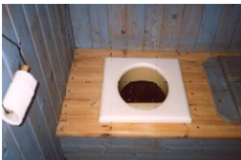
Bild: Utedass med urinsortande insats. ( www.avloppsguiden.se )
