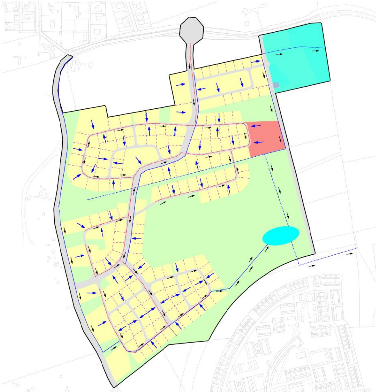
Figur 27. Översiktligt lösningsförslag för planområdet, där blå pilar visar på flödesriktning och ljusblå ovalformad yta i sydöst redovisar schematisk placering av dammen.
