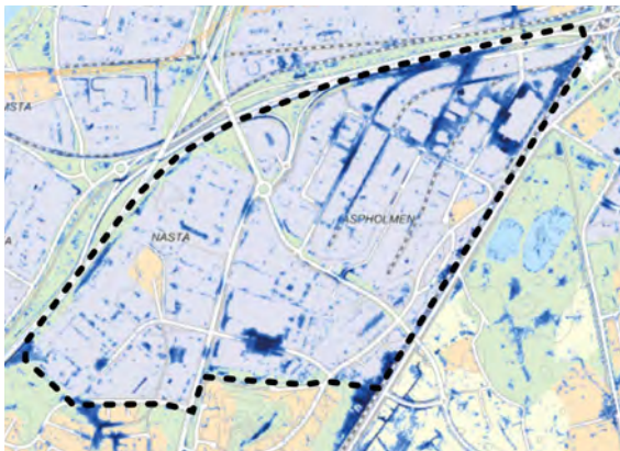
Karta: Skyfallsberäkning, blåmarkering visar maxdjup vid 100-årsregn. Mörkast blå visar djup > 0,5 meter.
